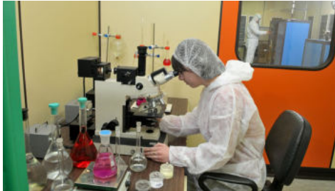
Контроль якості поверхонь підкладок та епітаксійних плівок НВП "Електрон-Карат"
